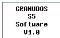
Über den Info-Button kann die eingesetzte Softwareversion abgefragt werden. Dies ist für Supportanfragen erforderlich.
