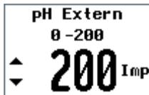
Am GRANUDOS wird die maximale Impulszahl (Frequenz) der externen Regeltechnik eingestellt bis max. 200 Impulse/Minute. Der GRANUDOS zählt nun immer die eingehenden Impulse pro Minute, berechnet daraus die angeforderte Dosierleistung und dosiert diese im nächsten Zyklus.
