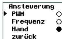
Diese Einstellung bestimmt die Ansteuerungsart der Chlor- und Säure-Dosierung und kann nur durch die Eingabe des Passwortes ausgeführt werden.
