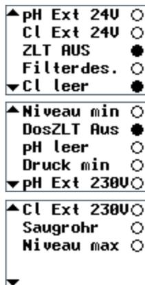
1. **pH Ext 24V**, → potentialfreies Signal für pH-Dosierung von externer Steuerung
