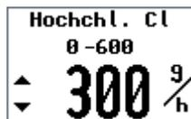
Zur Kontrolle sollte die Chlorkonzentration während der Hochchlorung **mehrmals überprüft** werden.
