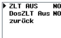
Bei einer Ansteuerung durch eine externe Steuerung (z. B. Zentrale Leittechnik ZLT), kann es notwendig sein, die Eingangssignale „ZLT AUS“ und „Dosierung ZLT AUS“ zu invertieren. Hier kann zwischen NC und NO gewechselt werden.
